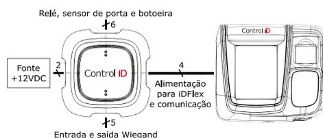
1. Para maior segurança na instalação, colocar o Módulo de Acionamento Externo (MAE) em uma região segura (parte interna da instalação).
