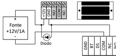
⚠ É importante conectar um diodo comum em série com o eletroímã. Para isso, conecte o catodo do diodo (parte listrada) ao terminal de alimentação positivo do eletroímã e o anodo ao GND do eletroímã.
