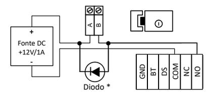
\* Caso a fechadura seja alimentada por uma fonte AC, o Diodo não deve ser utilizado na instalação.
