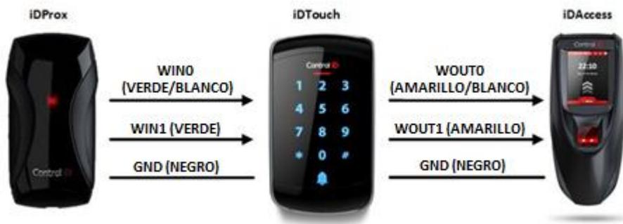
Figura 10 - Conexiones Wiegand
