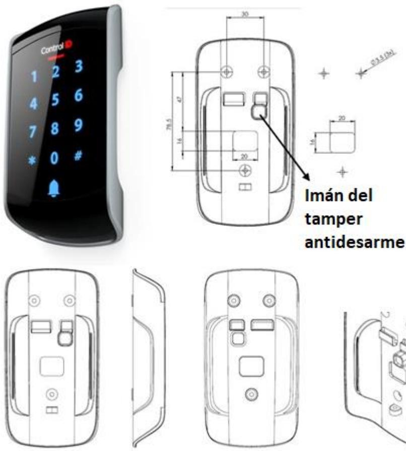
Figura 3 - Soporte de fijación
